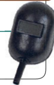
Escudo de segurança para serviços de soldagem, confeccionados em polipropileno, com cabo de material plástico de aproximadamente 12cm e 33mm de diâmetro. Possui visor fixo, com lente incolor e com filtro.
